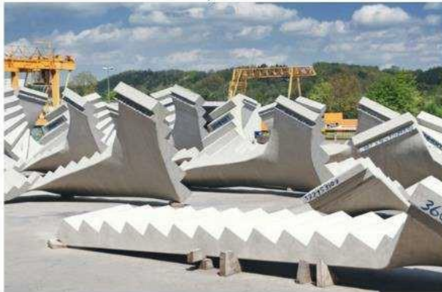
Obr. č. 1 – hotová schodiště na skladu ve výrobním závodě v Německu
