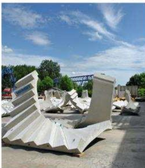
Obr. č. 1 – hotová točitá schodiště na skladu ve výrobním závodě v Německu
