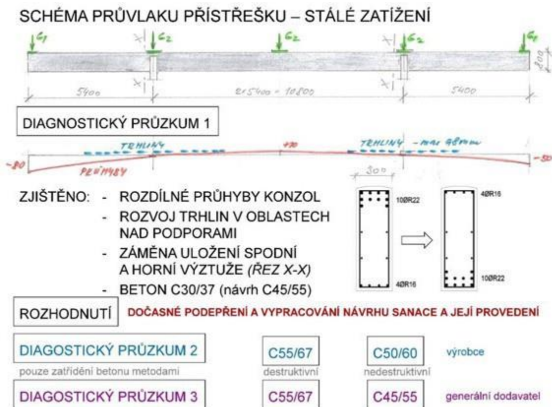
Obr. 10 Průhyby, trhliny a výsledky diagnostického průřezu průvlaku
