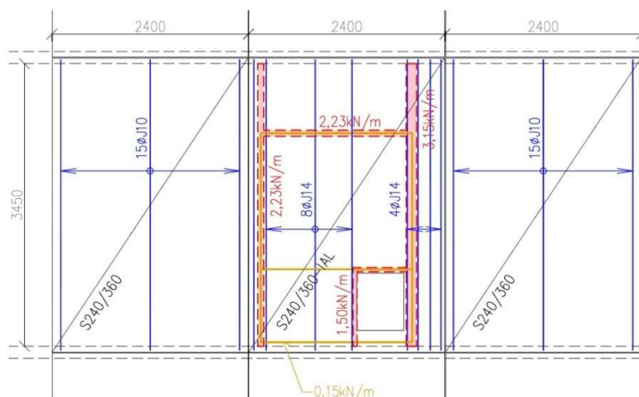
Obr. 3 Uspořádání bytového jádra a uvažované vyztužení panelů
